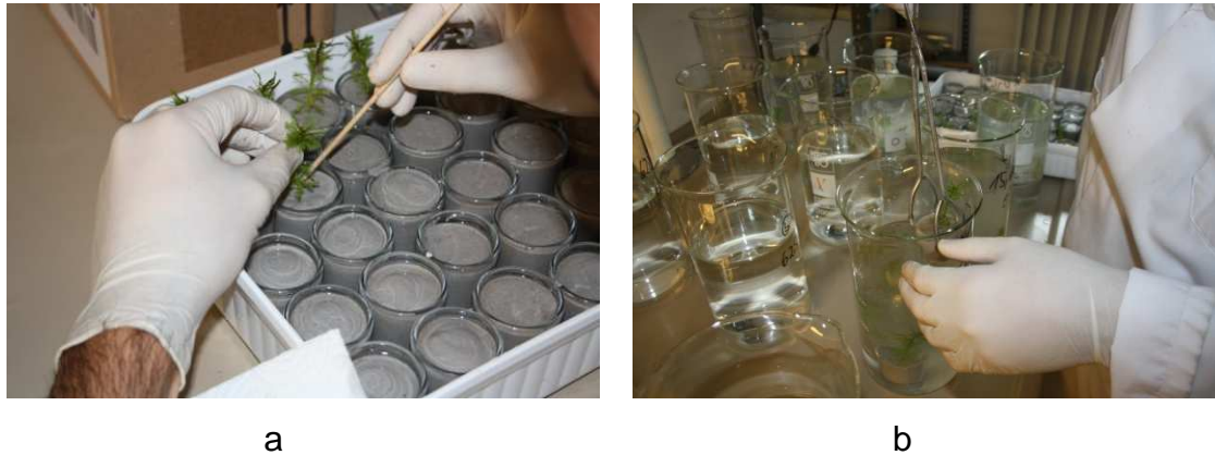
Abb 3.: Einsetzen der Pflanzen in Testgefäße und Überführen der Pflanzen in Expositionslösung
