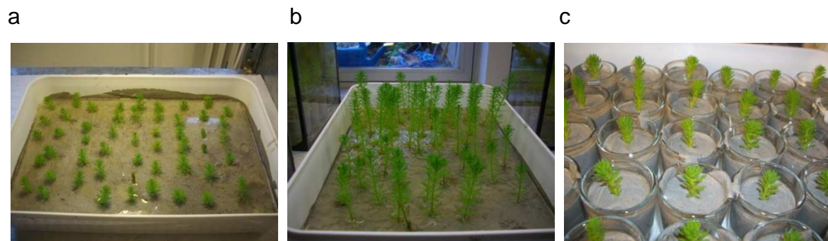
Abb. 4: Vorzucht der Pflanzen in OECD-Sediment. a: Einsetzen der Pflanzen in Sediment; b: Pflanzen nach zwei Wochen Wachstum; c: Umsetzen der Pflanzen in Testgefäße
